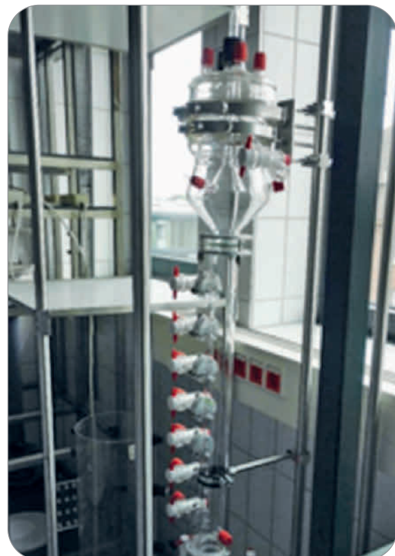
UASB-Reaktor 1 aus Kunststoff (oben) UASB-Reaktor 2 aus Glas (unten)
