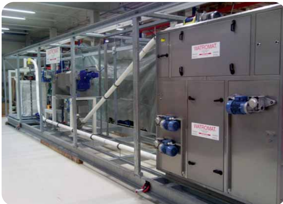
ACAT Schnecken- presse Typ AS 250 fertig vorinstalliert auf einer Watropur Bandtrock- nungsanlage
