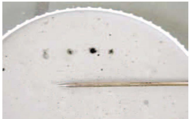
Test Abbindeverhalten: In fünf-Minuten Intervallen wird eine Nadel in die Probe gedrückt
