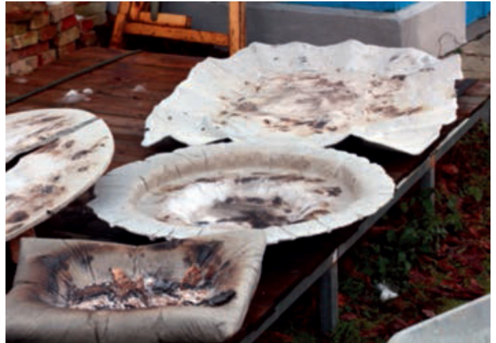
Die Schalen vor (links) und nach der Befuerung (rechts), leicht beschädigt, aber strukturell intakt.
