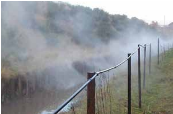
Leitung mit Hochdruckdüsen wird zum Zerstäuben von Ecosorb® bei diffusen Geruchssituationen verwendet.
