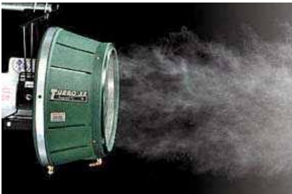
Ein Zerstäubungsventilator wird verwendet, um Ecosorb® bei lokalisierten Geruchssituationen zu zerstäuben.
