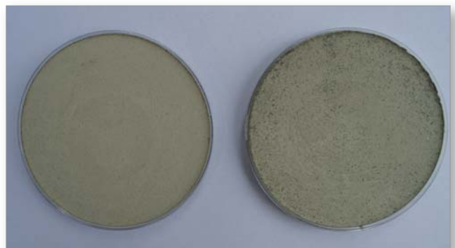
Abb. 7: Erzeugung einer homogenen Oberfläche und Verbesserung der Pigmentverteilung unter Verwendung eines pulverförmigen Dispergiermittels
