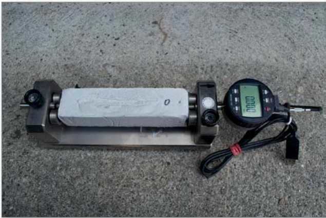
Abbildung 1: Bestimmung der Länge des Probekörpers mit einer elektronischen Messuhr
