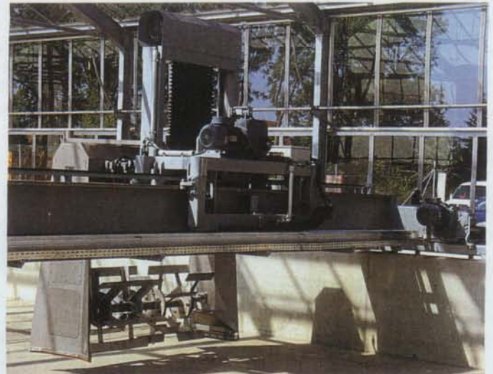
Der SchlammManager® ist mit Ultraschallsensoren versehen, die die automatische Höhenverstellung steuern.
